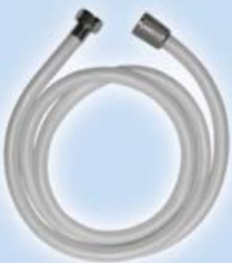
● Шланг ПВХ армированный нейлоновой нитью 1/2" – 1/2" конус 150 см ШД-512н 175 см ШД-712н 200 см ШД-912н M22 x 1,5 – 1/2" конус 150 см ШД-532н 175 см ШД-732н 200 см ШД-932н M22 x 1,5 – M22 x 1,5 150 см ШД-542н 175 см ШД-742н
